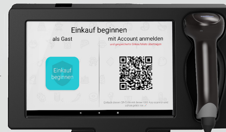
Écran tactile 10" étanche et résistant aux chocs avec système de scan intégré
